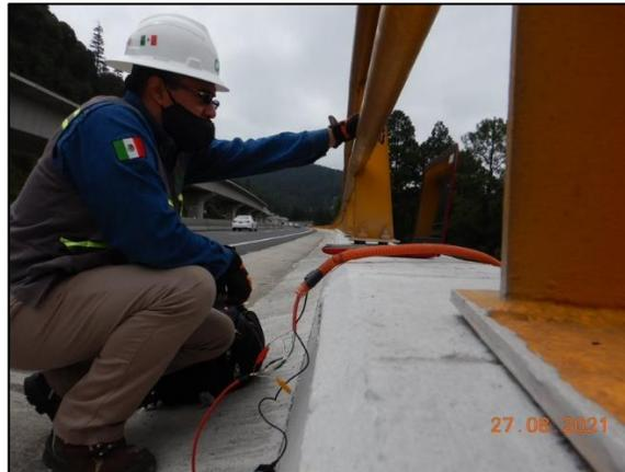
Ilustración. Campaña de medición de instrumentación del MTME.
