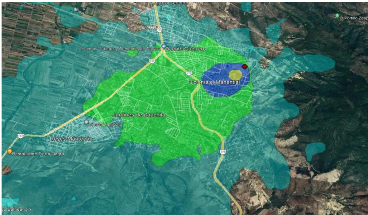
*Figura de Modelación de dispersión de CH4 y contaminantes en el radio de impacto para el SDF de Zaachila, obtenida del informe de estimación de la generación de biogás en el sitio de disposición final Villa de Zaachila, Oaxaca, 2023.
